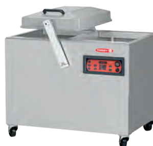
EVD-2C76 Bomba de vacío 63 m 3 / hr
